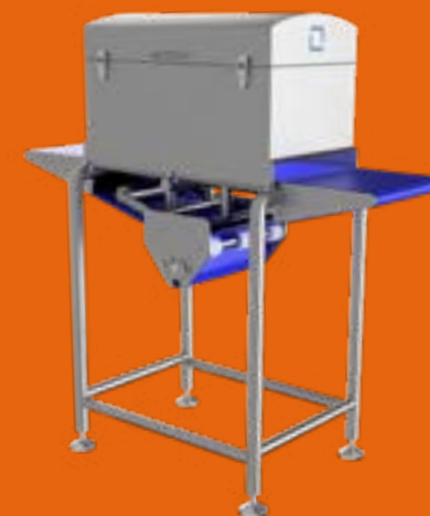
De transportband die gebruikt wordt in de visverwerking met daarop de 'vision robot' die de metingen uitvoert en data verzamelt.
