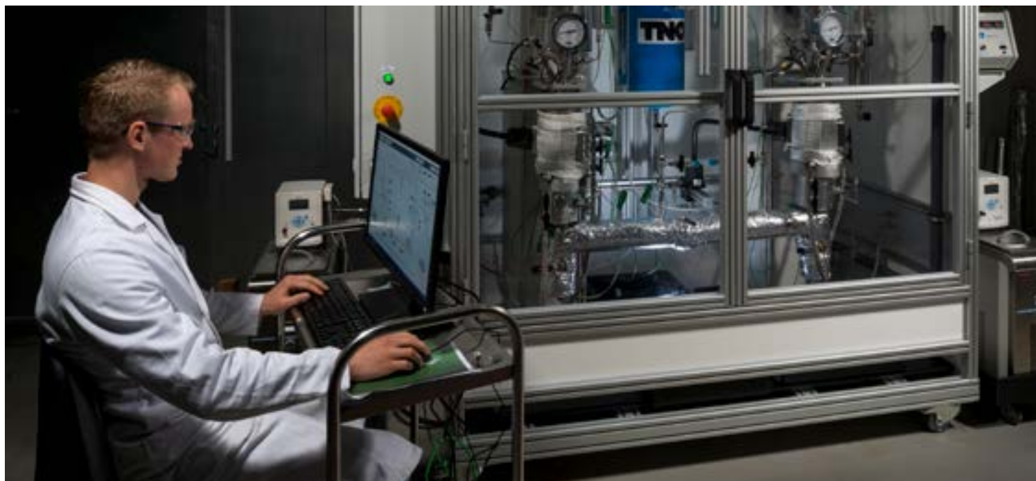
Proefopstelling voor de recycling van afgedankt kunststof door middel van oplosmiddelen (dissolutie).
